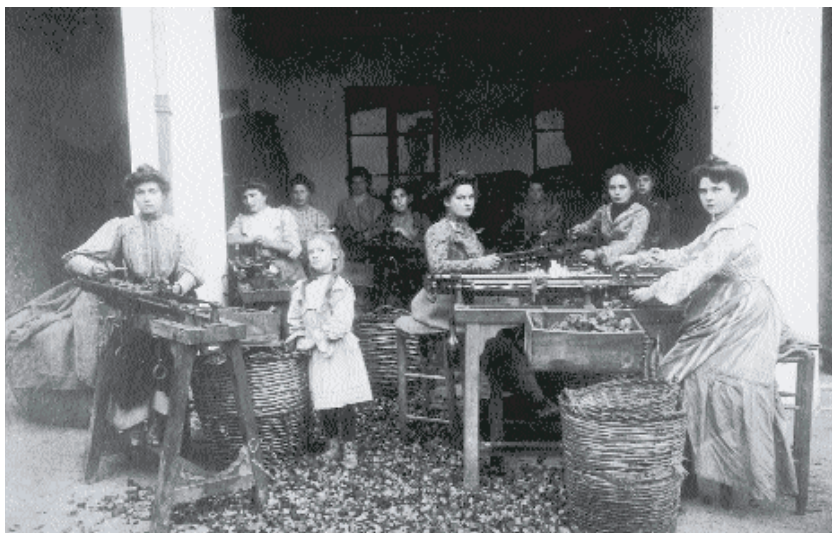
Treballadores de l'empresa de Joaquim Coris Codolar fent taps amb màquines de garlopa pels volts de la Primera Guerra Mundial. La implantació d'aquestes màquines comportà l'increment del personal femení a les fàbriques de taps de Llagostera a partir dels inicis del segle XX. (Fons Pompeu Pascual Coris)
